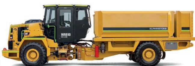
WR810 Camión lubricador: Tanque de petróleo de 5000 litros, 4 tanques de 300 litros, 1 x tambor de grasa, 2 x tambores de 166 litros c/u. Surtidores en la parte posterior. Este equipo elimina la necesidad de sacar los equipos de la mina para abastecer combustible y resolver mantenencias menores. Hacemos configuraciones personalizadas
