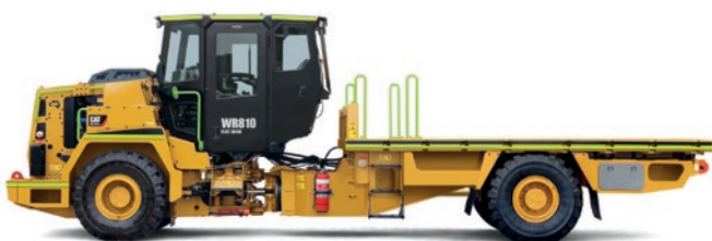
WR810 con Plataforma Plana: Solución perfecto para el transporte de repuestos, componentes, equipos, herramientas y personal de mantenimiento con seguridad dentro de la mina.
