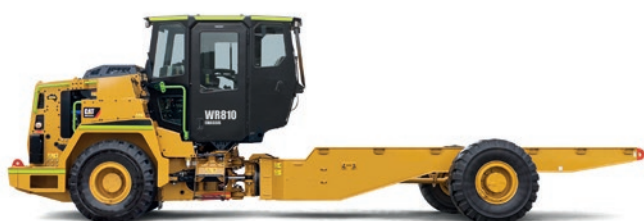
WR810 Cabina con Chasis: Chasis básico diseñado para la instalación de aplicaciones específicas.
